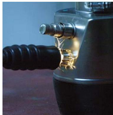
SLC820传感器在模拟的雷击波形下测试
